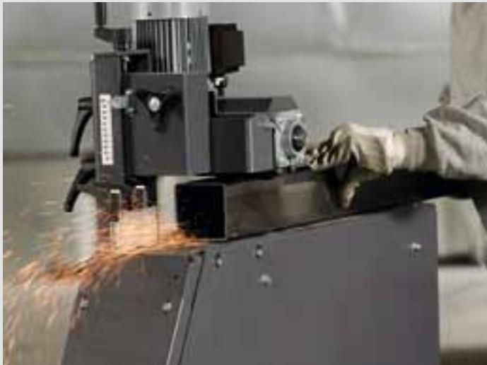
Даже с продольным шлифованием труб квадратного сечения, листового материала и профилей уникальный плоскошлифовальный модуль GRIT GIL справляется очень легко; так же просто стало переоборудовать ленточный шлифовальный станок в плоскошлифовальный. При этом размеры ленты базового станка сохраняются. Это решение GRIT находится на стадии оформления патента.
