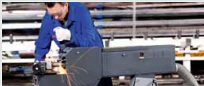
Независимо от объекта шлифования – трубы, профили или сплошной материал – модуль для шлифования закруглений GRIT GXR имеет оптимальную оснастку для этой задачи. Серийная комплектация включает точно и быстро устанавливаемые на нужный угол поперечные салазки, а также тиски с зажимными губками из нержавеющей стали и уникальной системой быстрого зажима. Все это гарантирует точность и безопасность шлифования.
