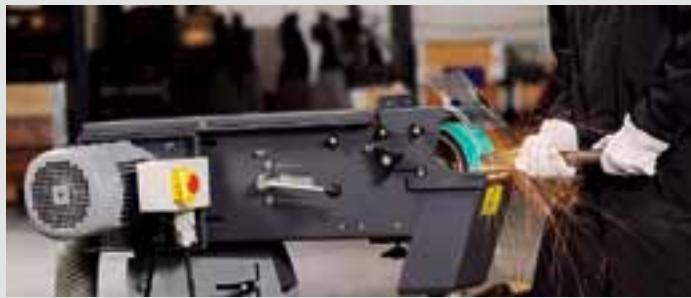
Благодаря мощному двигателю ленточные шлифовальные станки GRIT GX 75 чрезвычайно продуктивны в работе, что гарантирует высокую производительность съема за короткое время. Станки GRIT GX 75 и GRIT GX 75 2H отличаются особенно низким уровнем вибрации при использовании, а их запатентованная система натяжения ленты облегчает точную обработку.
