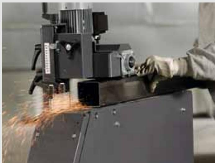
Даже с продольным шлифованием труб квадратного сечения, листового материала и профилей уникальный плоскошлифовальный станок GRIT GILS справляется очень легко. При этом размеры ленты базового станка сохраняются. Это решение GRIT находится на стадии оформления патента.
