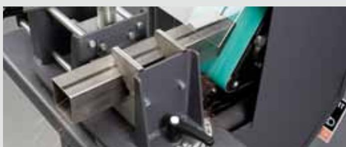
Чтобы обеспечить особую точность при шлифовании скосов, компания GRIT разработала специальную шлифовальную пластину. Простота установки делает ее уникальной. Пластина для шлифования скосов поставляется по дополнительному заказу.
