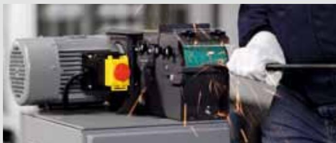
Идеальное решение для шлифования, снятия фаски, удаления заусенцев с мелких деталей. В сочетании с опорной стойкой GRIT GIXBE обеспечивается эффективное удаление шлифовальной пыли через фильтр для ее задержания.
