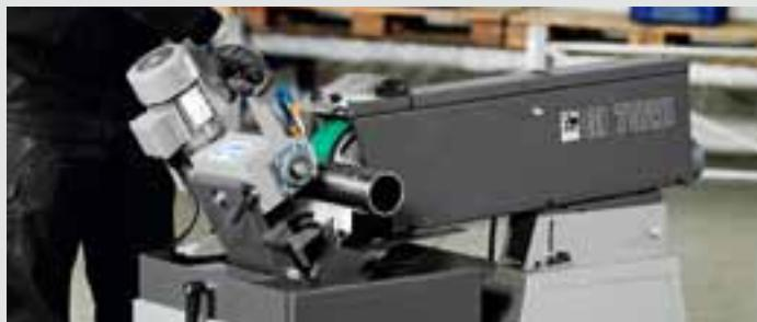
Экономичное автоматизированное круглое шлифование труб: от черновой до завершающей обработки поверхности. Использование со смазочно-охлаждающим модулем GRIT GXW позволяет добиваться превосходных результатов при низкой рабочей температуре.
