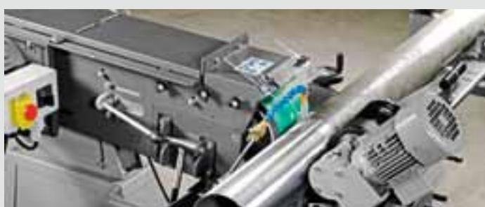
Лучшие результаты работы достигаются при мокром шлифовании. Благодаря эффективному охлаждению с помощью смазочно-охлаждающего модуля GRIT GXW температура заготовки при обработке значительно сокращается, что особенно важно при работе с нержавеющей сталью. Исключается перегрев, предотвращается коррозия. В сочетании с дополнительной системой отвода воды обрабатываемая заготовка автоматически очищается от шлифовальной пыли и избытка жидкости.
