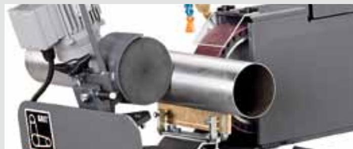
С учетом различного качества поверхности заготовки в комплект поставки входят разные направляющие. Направляющие из латуни рассчитаны на необработанные поверхности (например, с коррозией, окалиной и т. д.) или на сухое шлифование. Для завершающей поверхностной обработки с использованием смазочно-охлаждающей жидкости идеальным решением будут нейлоновые направляющие.
