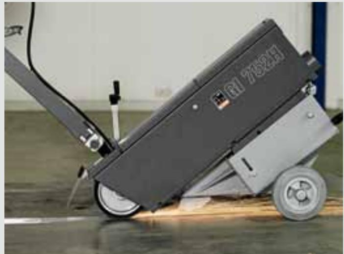
Комбинация модуля GRIT GIM с базовыми ленточными шлифовальными станками GRIT GI подходит для зачистки даже самых высоких сварных швов.
