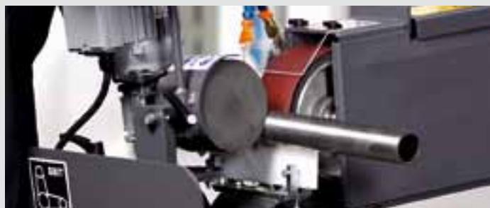
Круглошлифовальный модуль GRIT GXC удивительным образом сочетает идеальное качество поверхности и высокую скорость обработки труб и валов. Скорость подачи бесступенчато регулируется с учетом обрабатываемого материала до макс. 2 м/мин.
