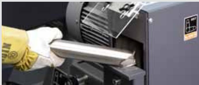
Оптимальное решение после шлифования труб и профилей сечением до 150 мм. Очень широкая поверхность обработки благодаря двум проволочным щеткам, установленным параллельно друг другу.
