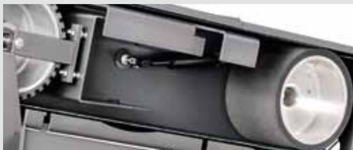
Пневматический пружинный механизм натяжения компенсирует допуски размера лент. Его комбинация с приводным шкивом с полиуретановым покрытием обеспечивает оптимальное натяжение ленты, исключая проскальзывание.
