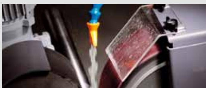
Мокрое шлифование с использованием смазочно-охлаждающего модуля GRIT GXW значительно улучшает качество поверхности: шлифовальная пыль немедленно связывается, а благодаря охлаждению увеличивается срок службы шлифовальных лент. За счет сниженного теплообразования при шлифовании снижается опасность коррозии труб из нержавеющей стали. Замкнутый контур обеспечивает экономичное расходование смазочно-охлаждающей жидкости.
