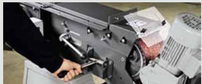
Круглошлифовальный модуль GRIT GIC с ленточным шлифовальным станком GRIT GI устанавливается несколькими простыми действиями.
