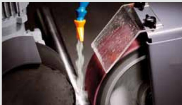
Модуль для шлифования и полирования круглых материалов: от грубой до финишной шлифовки.
