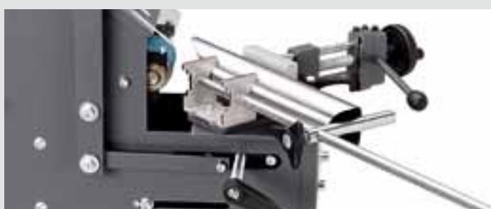
Дополнительно устанавливаемый на модуль для шлифования закруглений GRIT GXR упор продольного хода обеспечивает неизменно точные результаты в серийном производстве. Он монтируется отдельно и регулируется по длине до 1000 мм.
