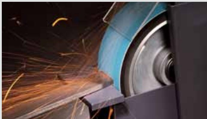
Производительный ленточный шлифовальный станок в исполнении с одной или двумя скоростями вращения – база модульной серии GRIT GX. Также он может применяться отдельно в качестве полноценного ленточного шлифовального станка.
