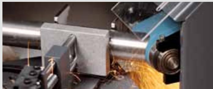
Обширный ассортимент контактных роликов GRIT охватывает все распространенные диаметры труб. Так, модуль для шлифования закруглений позволяет выполнить точное шлифование труб Ø 16–75 мм под углом от 30 до 90°.
