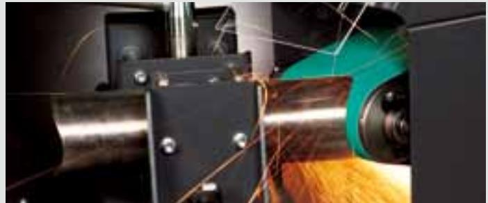
Благодаря системе быстрого зажима заготовка в мощных тисках заменяется максимально просто и рационально. Поставляемые в комплекте зажимные губки из нержавеющей стали предотвращают контактную коррозию при работе с заготовками из нержавеющей стали. Для эффективной работы системы отсоса требуется пылеудаляющий патрубок (№ для заказа 6 99 02 182 00 0).
