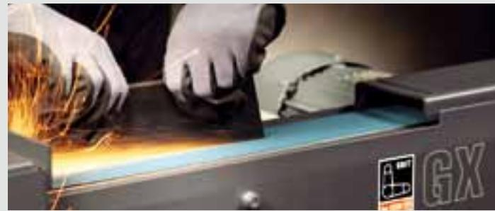
Плоское шлифование – стандартная задача для оборудования GRIT. Большая поверхность шлифования, 75 x 420 мм, – такая же неотъемлемая характеристика обоих станков GRIT GX 75, как и наличие регулируемого по высоте стола для плоского шлифования и простая регулировка ленты.
