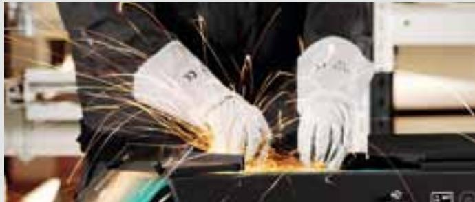
Съем металла с плоской поверхности выполняется после открытия или снятия верхней крышки регулируемого по высоте стола. Графитовое покрытие между шлифовальной лентой и опорной поверхностью представляет собой отличную скользящую основу, которая защищает шлифовальную ленту.
