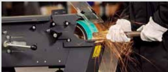
Высокопроизводительные ленточные шлифовальные станки для применения в жестких условиях эксплуатации. Базовая модель модульной серии GRIT GI, в исполнении с одной или двумя скоростями вращения. Также может применяться отдельно в качестве полноценного ленточного шлифовального станка.
