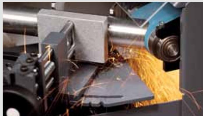
Модуль для шлифования закруглений на различных заготовках, например трубах круглого и прямоугольного сечения, плоских материалах и профилях.
