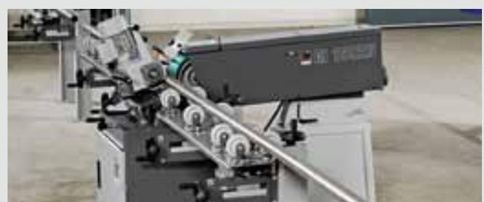
Обработка труб самых разных диаметров длиной до 6 м возможна при заказе дополнительных трубных направляющих.
