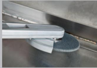
Сварные швы шлифуются для необходимого профиля с помощью диска из нетканого полотна (средн.). Профилировочный брусок придаст диску из нетканого полотна желаемую форму.
