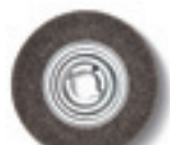
Проволочная щетка Ø 250 x 60 mm, с высокой прочностью проволоки для особенно экономичного применения, крепежное отверстие Ø 51 mm. Проволока толщиной 0,2 mm для тонкостенных труб и профилей. Проволока толщиной 0,35 mm для универсального применения. Проволока толщиной 0,5 mm для толстостенных труб и профилей и эффективного удаления заусенцев. Исполнение из стали
