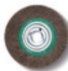
Проволочная щетка Ø 250 x 60 mm, с высокой прочностью проволоки для особенно экономичного применения, крепежное отверстие Ø 51 mm. Проволока толщиной 0,2 mm для тонкостенных труб и профилей. Проволока толщиной 0,35 mm для универсального применения. Проволока толщиной 0,5 mm для толстостенных труб и профилей и эффективного удаления заусенцев. Исполнение из высококачественной стали
